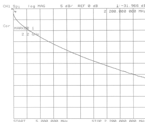
Rysunek 3: Tłumienność kabla NS100TRI
